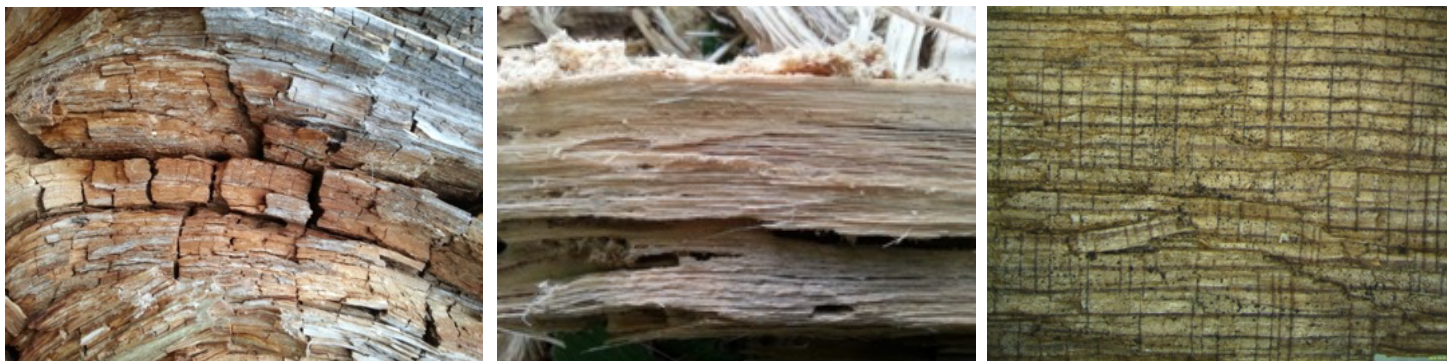
Figure 10 – De gauche à droite : pourriture cubique, pourriture blanche et pourriture molle
